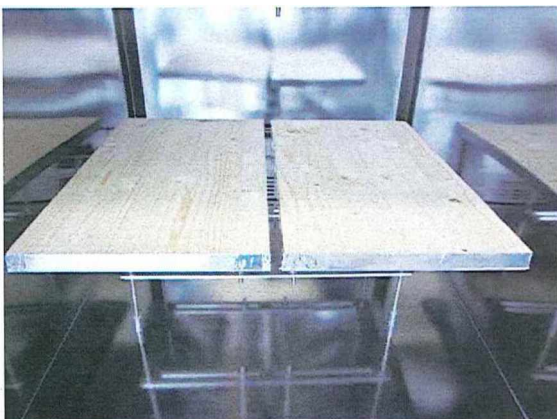
Abbildung 1: Prüfkörper in der Emissionsprüfkammer
